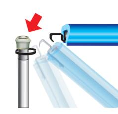
Die Curtain-Wall-Kopfleiste in das Kopfstück RingTop der Teleskopstange einhängen.
