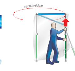
An der anderen Seite der Kopfleiste die nächste (nicht vollständig ausgezogene) Teleskopstange befestigen und ausfahren, bis der Schaumstoff an der Decke anliegt.
