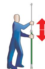
Verriegelung gedrückt halten, Teleskopstange ausfahren, zwischen Boden und Decke einklemmen und Verriegelung loslassen.
