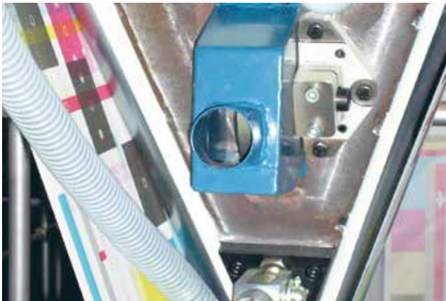
Saughaube am Schneidmesser einer Druckerpresse
