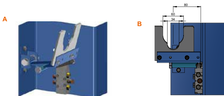
Halter für handgeführte Werkzeuge mit 5/2 Wegeventil.
