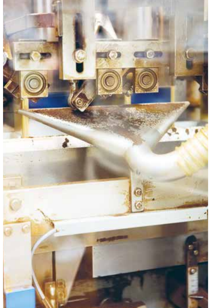
Absaugung an einer Verpackungsmaschine der Nahrungsmittelindustrie
